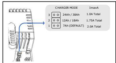
2402ST, impostato su **MODALITÀ 3** con 2x 38Ah batterie, possono supportare un carico massimo di **1.0 A (ImaxA)** durante la ricarica delle batterie
