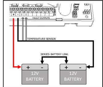
**ATTENZIONE: il cavo della batteria fornito contiene un sensore di temperatura; NON tentare di modificare questo cavo in alcun modo e non utilizzare un metodo alternativo per collegare le batterie.**
