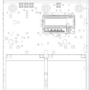
2405ST in contenitore H con batterie da 24 Ah (batteria omessa per chiarezza)
