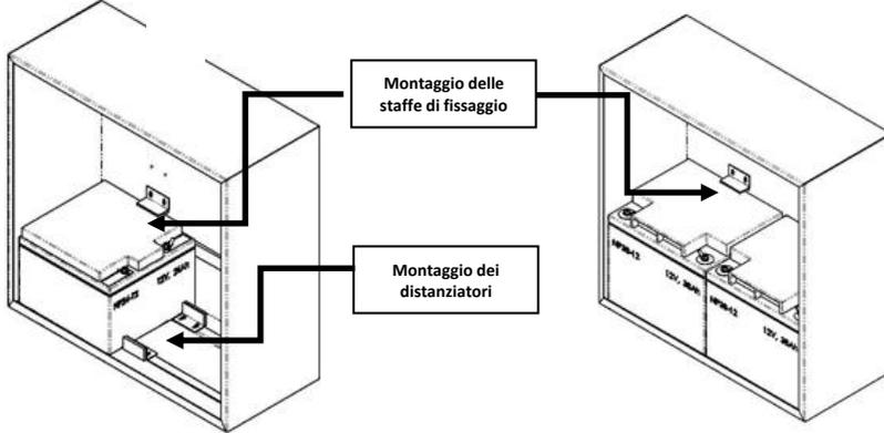
25. Il contenitore per batterie Battery Box è utilizzato per batterie da 65 Ah ed è progettato per essere montato a pavimento. NON deve essere sospeso a parete.
