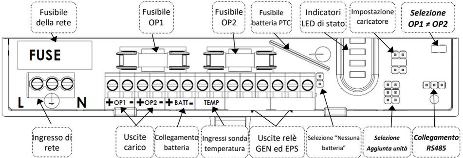
**Funzione di monitoraggio della trasmissione dell'alimentazione a doppio percorso (DUAL PATH)**
