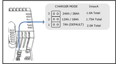
b. **ESEMPIO (b):** per i sistemi antincendio conformi allo standard EN54, un 2405ST, impostato alla **MODALITÀ 2** con 2 batterie da 24 Ah, può supportare un carico massimo di **4,0 A (Imax A)** durante la carica delle batterie.
